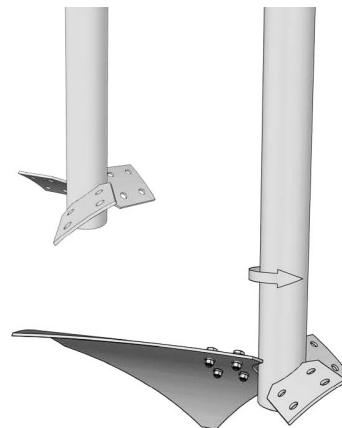
Spiralformig axialflödesprofil. Rotationsriktning: moturs, Tryckriktning: uppåt Icke-standardböj
